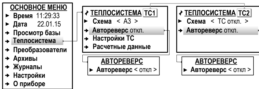
Рис.17. Вид меню при назначении схем теплоучета (режим СЕРВИС).
