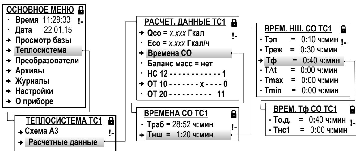
Рис.41. Вид окон индикации временных параметров в системе отопления (режим РАБОТА).
