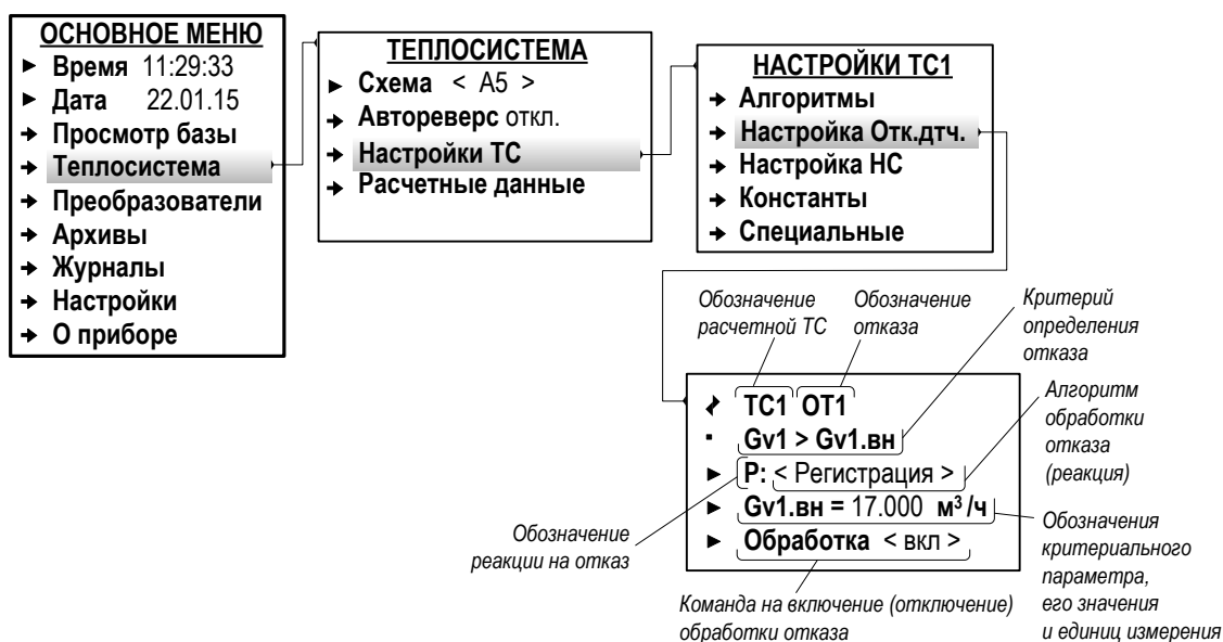
Рис.36. Вид меню настройки обработки отказов (режим СЕРВИС).
