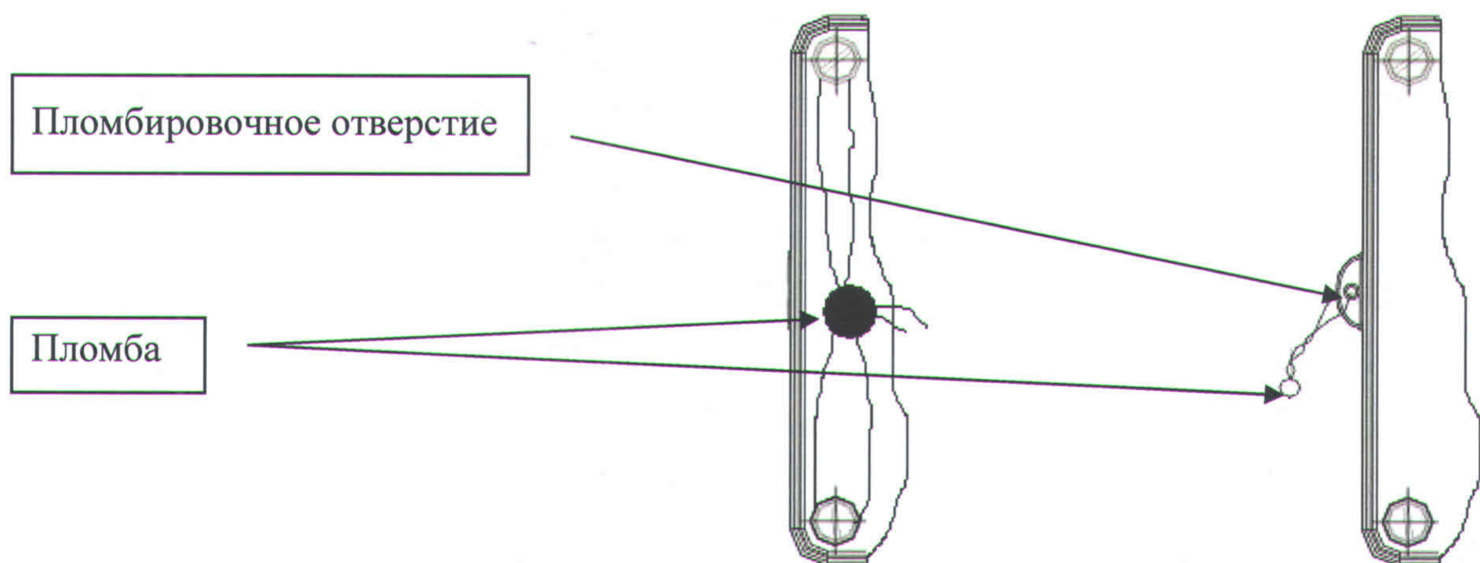
Рисунок 2 - Схема пломбировки тепловычислителей «ВЗЛЕТ ТСРВ»
